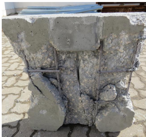
Figura 4.40 – Laje do conector TPU_AR10 em betão C20/25
