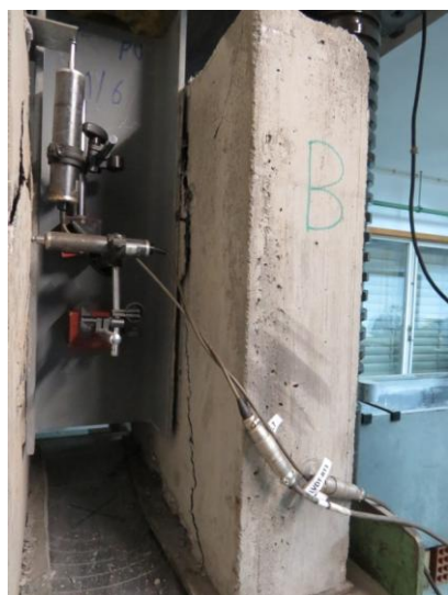
Figura 4.33 - Modo de rotura intermedio do conector TPU_AR10 em betão C25/30
