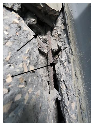
a) Armadura de reforço do conector TPU_AR10_B em betão C20/25 b) Armadura de reforço do conector TPU_AR16_A em betão C20/25
