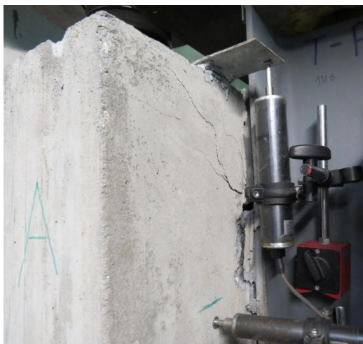
Figura 4.31 - Modo de rotura intermedio do conector TP em betão C25/30
