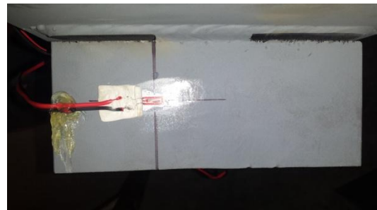
Figura 3.11 - Colocação dos extensómetros
