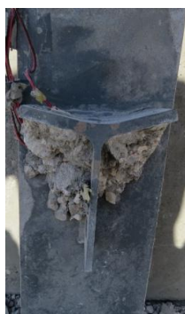
a) Cone de betão no conector TPU_AR10_B b) Cone de betão no conector TPU_AR16_B Figura 4.37 – Cone de betão nos conectores TPU_AR10_B e TPU_AR16_B em betão C20/25
