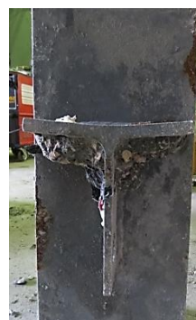
a) Cone de betão no conector TPU_AR10_B b) Cone de betão no conector TPU_AR16_B Figura 4.37 – Cone de betão nos conectores TPU_AR10_B e TPU_AR16_B em betão C20/25
