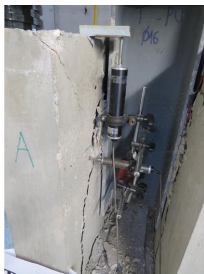
Figura 4.34 - Modo de rotura intermedio do conector TPU_AR16 em betão C20/25
