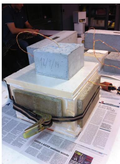
Figura 3.7 - Molde dos provetes 150mmx150mmx100mm com placas de poliestireno extrudido.
