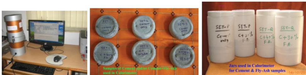
Figura 2.4 – Equipamento utilizado no ensaio semi-adiabático.
