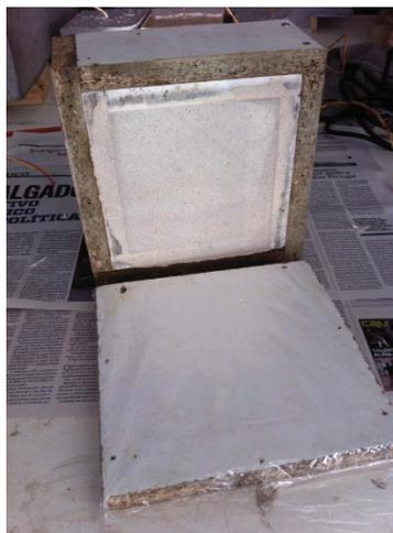
Figura 3.6 - Molde dos provetes 150mmx150mmx100mm.
