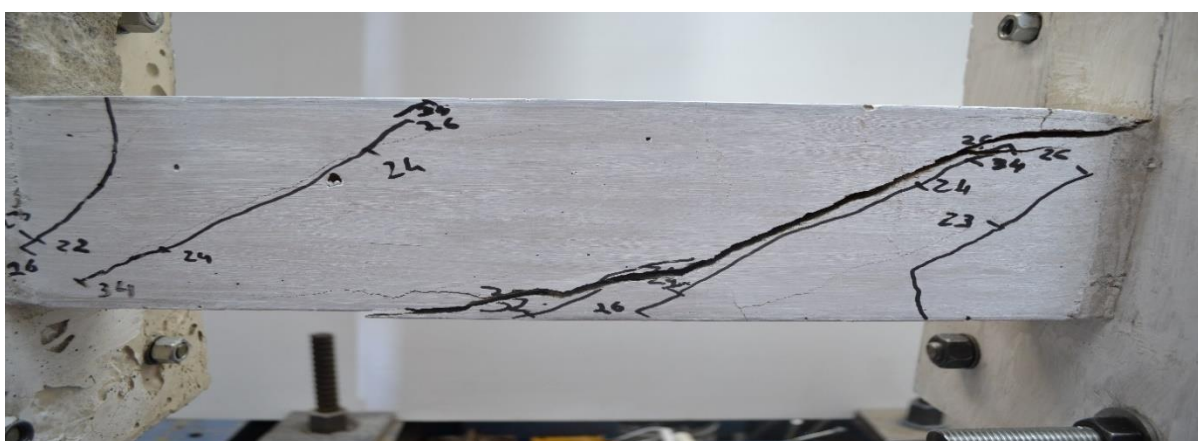
Figura 4. 8 - Rotura do Provete 1 .
