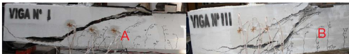
Figura 2.7 - Modos de rotura de vigas com estribos (adaptada de Lopes et al , 2008)
