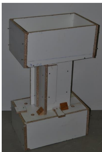
Figura 3.7 - Perspetiva do modelo de cofragem dos provetes.
