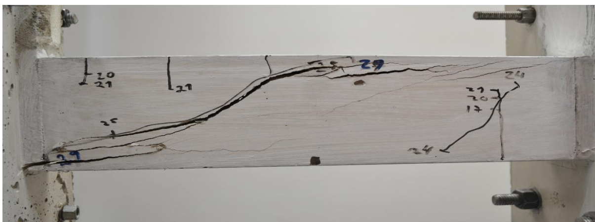
Figura 4. 25 - Rotura do Provete 4 .
