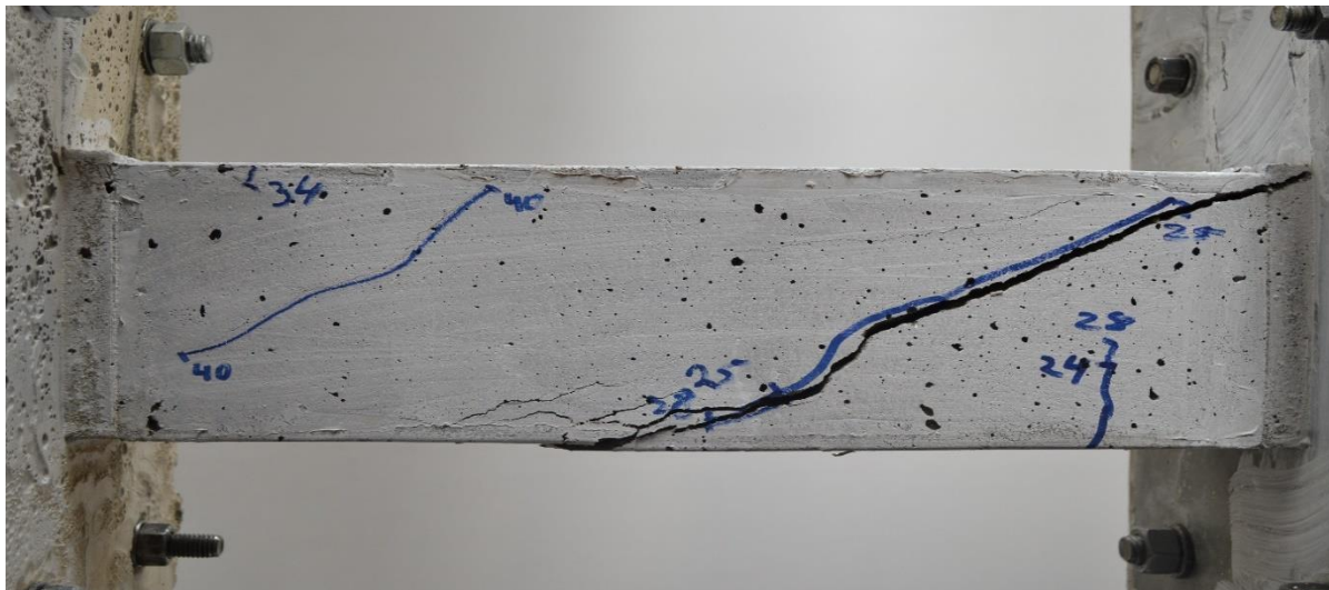
Figura 4.13 - Rotura do Provete 2 .
