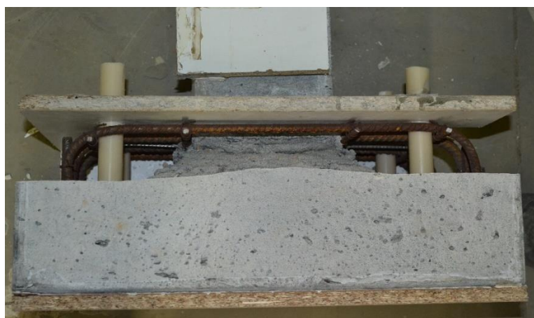
Figura 4.18 - Defeito construtivo no Provete 3 .
