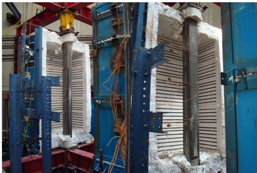
Figura 3.4– Pormenor de isolamento do provete e do forno eléctrico
