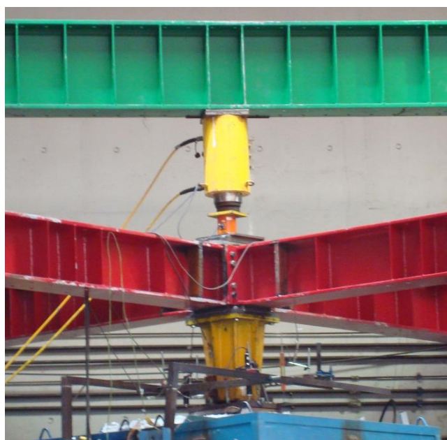
Figura 3.5– Carga de compressão aplicada ao elemento por via de um macaco hidráulico
