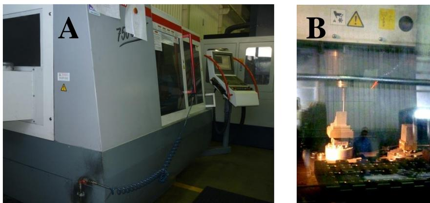
Figura 4.4 - Exterior (A) e interior (B) da máquina de eletroerosão por penetração.
