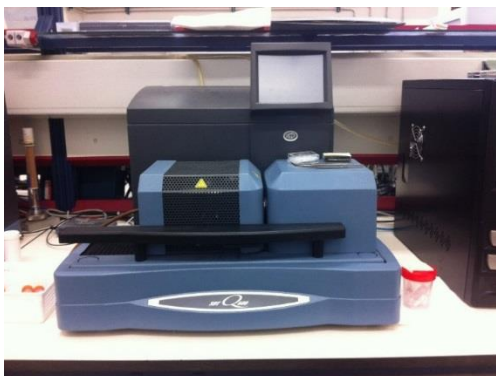
Figura 3.9. Calorímetro diferencial de varrimento e termogravitómetro SDT Q600 V20.9 Build utilizado na caracterização térmica das amostras.
