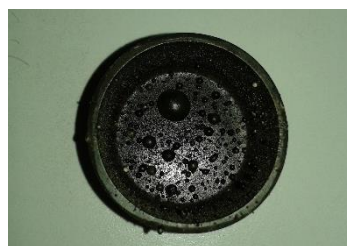
Figura 3.8. Exemplo do resíduo que fica no cadinho no final do processo de combustão das lamas celulósicas, 1ª recolha, na bomba de oxigénio.
