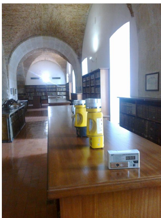
Figura 22: Procedimento de avaliação da concentração de fungos e bactérias/PS32
