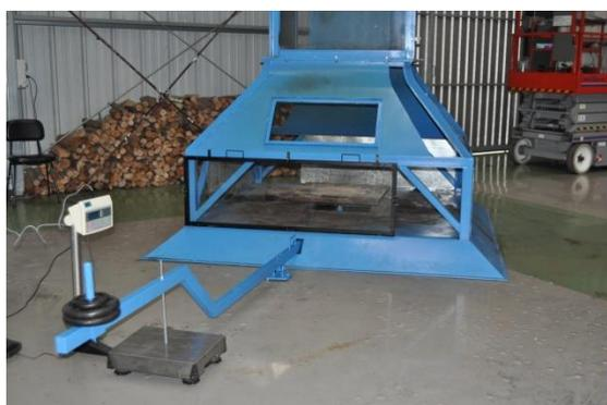
**Figura 3.5.** Montagem da balança para aferição da perda de massa
