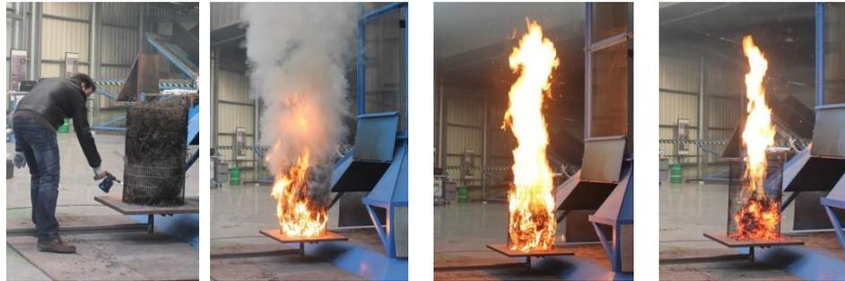
**Figura 3.9.** Ensaio completo com imagens de quatro fases distintas da formação do vórtice de fogo
