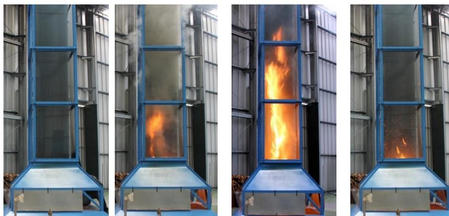
**Figura 3.10.** Ensaio completo com imagens de quatro fases distintas da formação do vórtice de fogo
