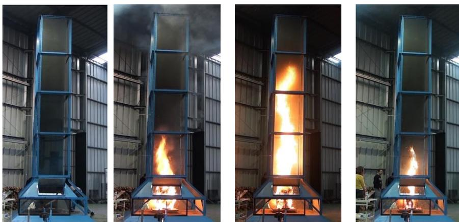
**Figura 3.8.** Ensaio completo com imagens de quatro fases distintas da formação do vórtice de fogo
