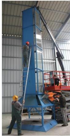
**Figura 3.14.** Montagem do GV após deslocação de local com elevação de 50 centímetros na altura do túnel
