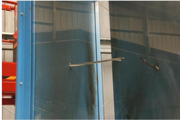
**Figura 3.12.** Tubos de Pitot montados na lateral da chapa
