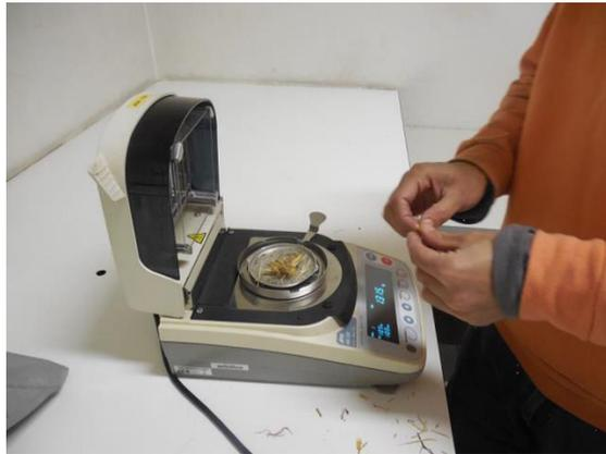
**Figura 3.4.** Analisador de teor de humidade
