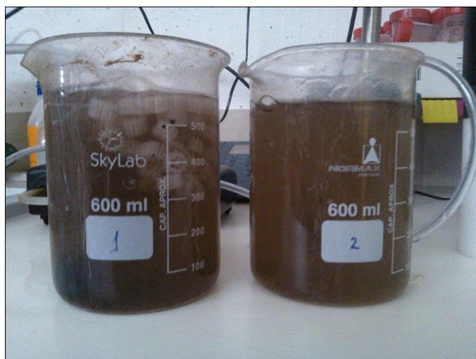
**Figura 22** – Reatores: **1** – Sistema com suportes; **2** – Sistema sem suportes.
