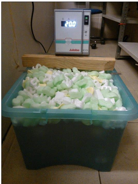
**Figura 15** – Tanque para medição de CBO<sub>5</sub>.
