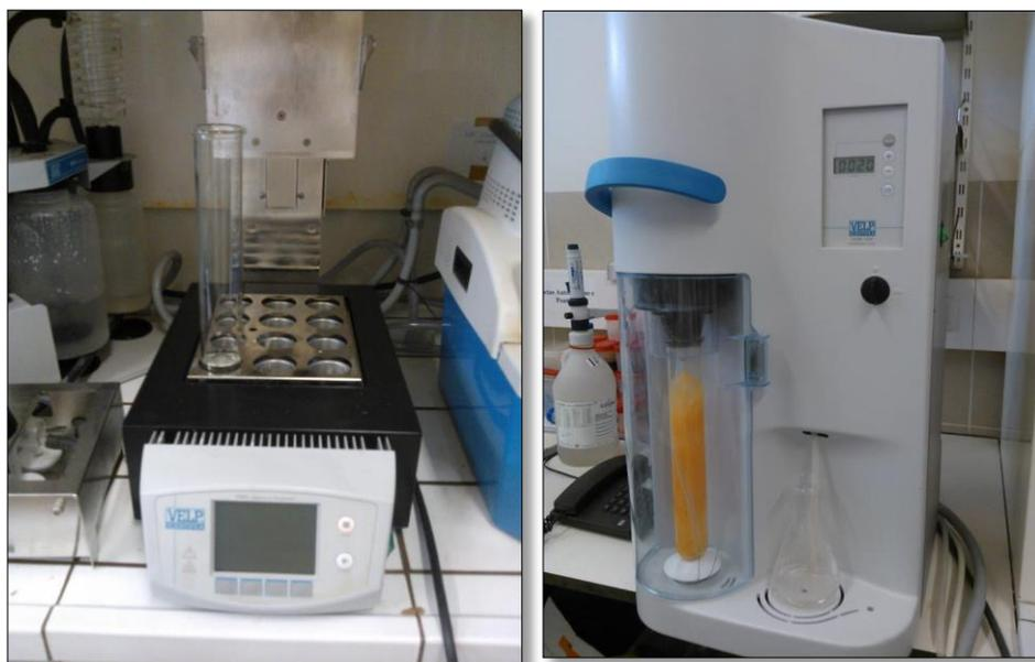
**Figura 17** – a) Aparelho de digestão VELP SCIENTIFICA DKL; b) Aparelho de destilação VELP UDK 129.
