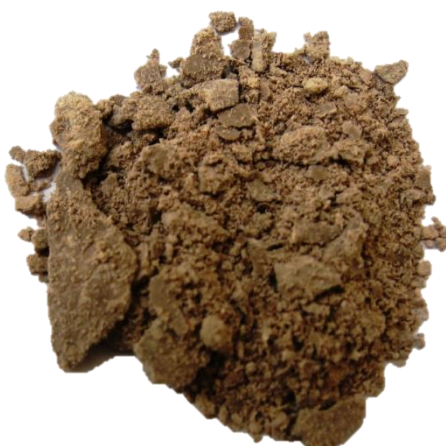
Figura 3.3 Casca de ovo com membrana após moagem com atmosfera controlada de nitrogénio.
