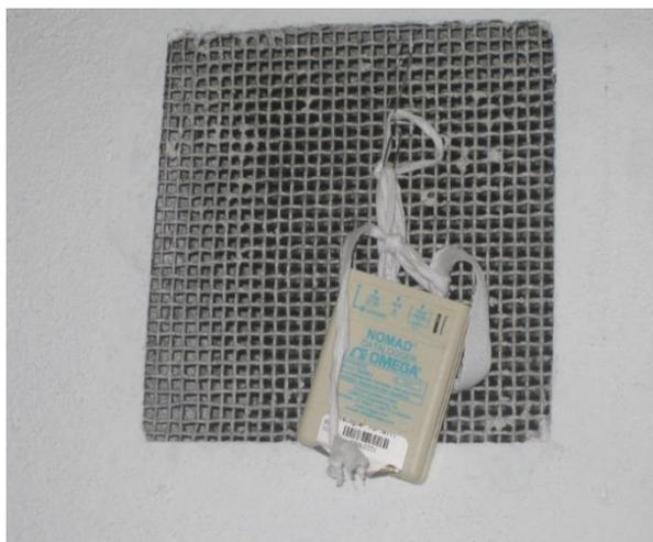
**Figura 6- Grelha de ventilação com datalogger**
