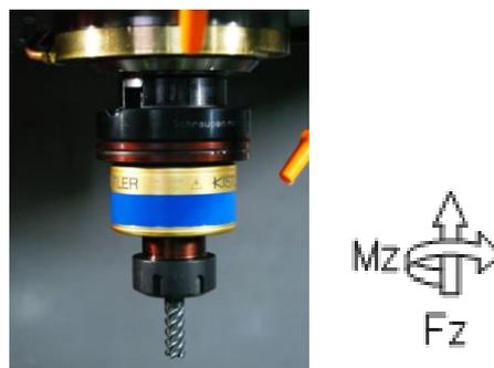
**Figura 3.14.** Dinamómetro rotativo e esforços medidos pelo instrumento.
