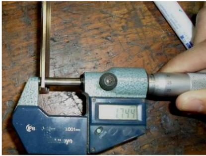
Figura 3.15. Medição com um micrômetro.
