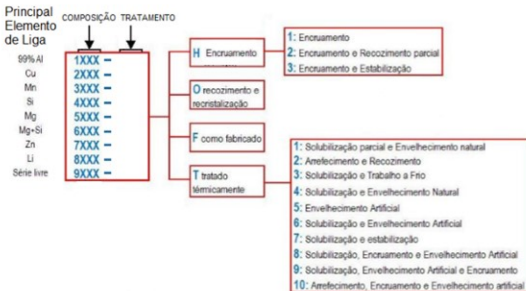
Figura 2.1. Esquematização simplificada da classificação das ligas e tratamentos das ligas de alumínio
