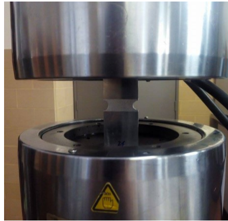
Figura 3.8 (esq.) Máquina de Ensaios de Fadiga INSTRON Figura 3.9 (centro) Pormenor da colocação do provete Figura 3.10. (dir.) Monitorização constante do ensaio através do Software
