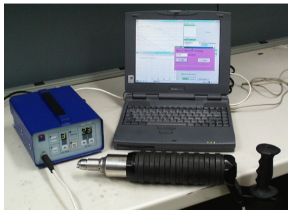
Figura 2.4. Equipamento utilizado na técnica do Ultrasonic Impact Technology, Esonix®UIT [20]
