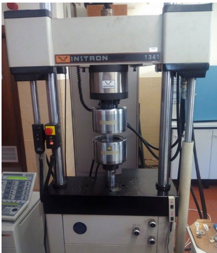
Figura 3.8 (esq.) Máquina de Ensaios de Fadiga INSTRON Figura 3.9 (centro) Pormenor da colocação do provete Figura 3.10. (dir.) Monitorização constante do ensaio através do Software
