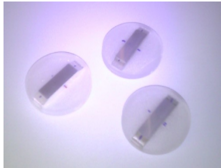
Figura 3.3. Seções transversais dos provetes dos vários tratamentos
