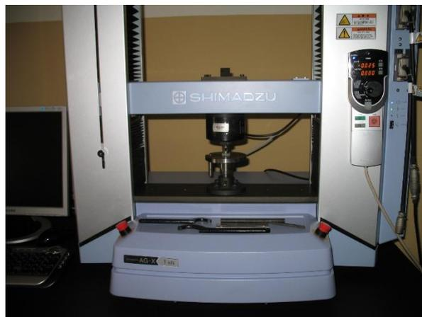
Figura 2.16 Equipamento de tração-compressão
