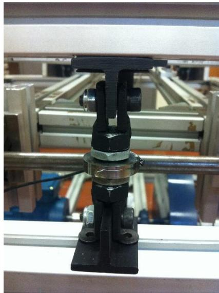
Figura 2.15 Célula de carga com suportes
