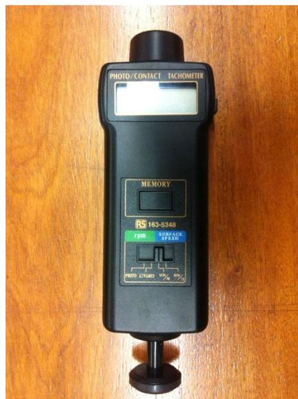
**Figura 2.20 Tacómetro digital**
