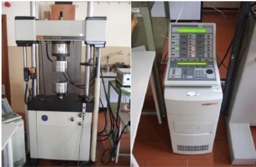
Figura 3.7 Máquina de ensaio de fadiga e sistema de controlo de dados.
