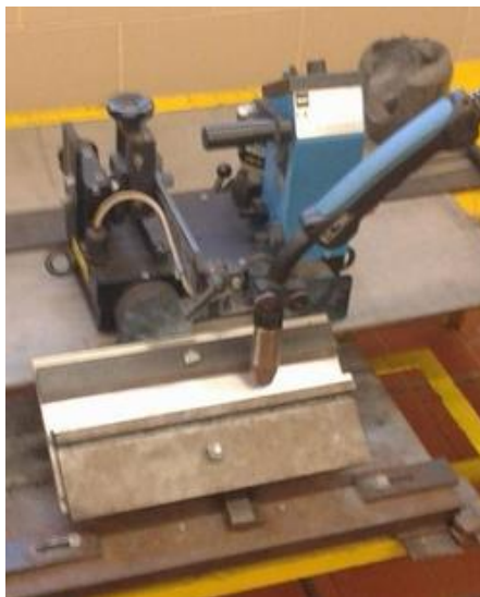
Figura 3.2. Soldadura MIG, carro de soldar e suporte das placas.
