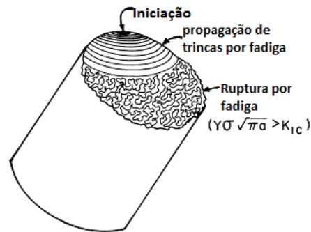
Figura 2.10. Representação esquemática da superfície de ruptura por fadiga (adaptado de [14]).
