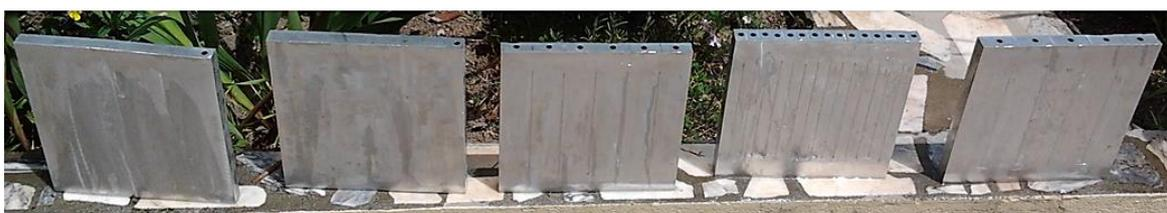
**Figura B. 7.** Provetes depois do acabamento superficial.
