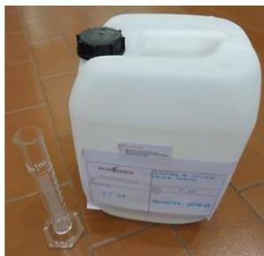
**Figura 3.15.** Recipiente com o PCM RT21 da *Rubitherm* e proveta graduada.
