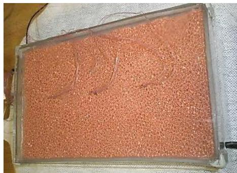
**Figura 2.6.** Parafina incorporada em “metal foams”, neste caso de cobre [13].
