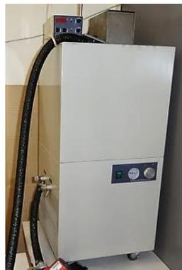
**Figura 3.9.** Banho termostaticado para calibrações.
