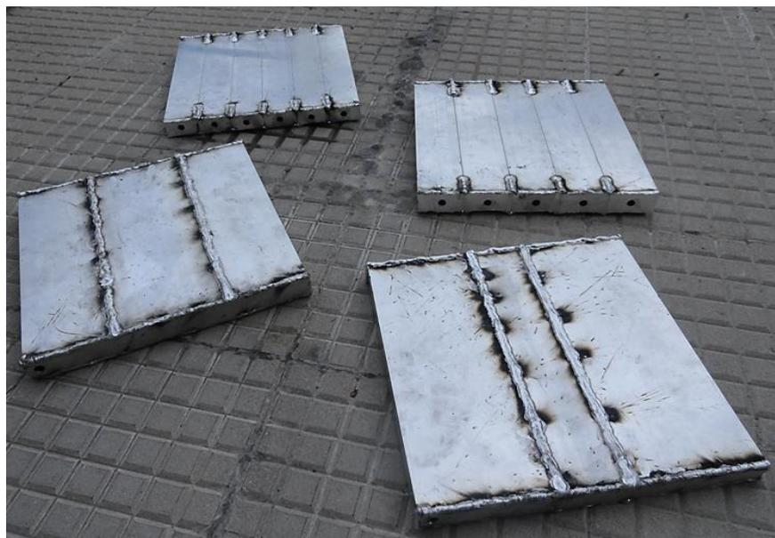
**Figura B. 6.** Provetes acabados de soldar.
