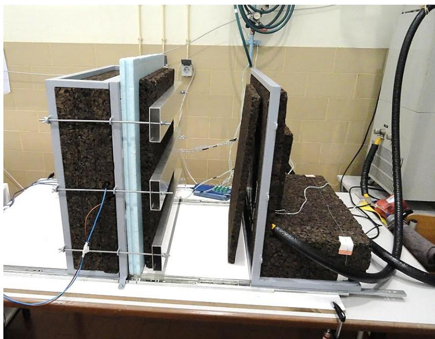
Figura D. 2. Início do ensaio de aquecimento e uniformização da temperatura da placa fria.
