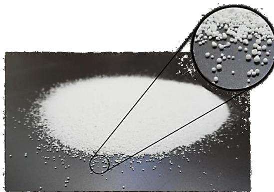
**Figura 3.14.** Microcápsulas de PCM - *Micronal*<sup>®</sup> *DS 5001 X*.
