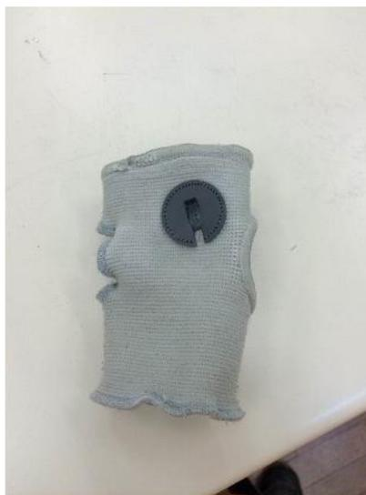
Figura 3.9 - Luva e encaixe feito em CNC para encaixar o acelerômetro
