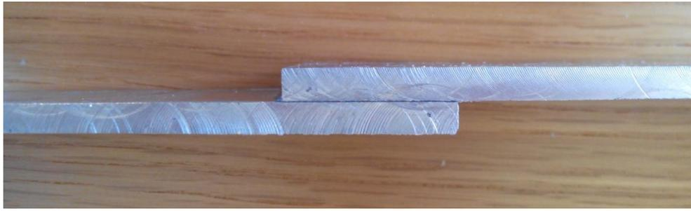
**Figura 3.2.** Aspeto final da junta, num provete de 0°.
