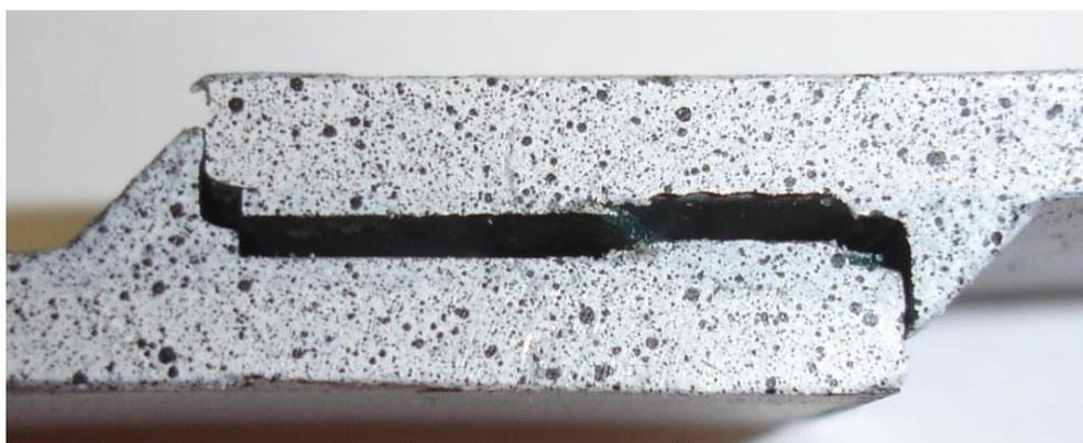
**Figura 4.2.** Rotura num provete de 45°.
