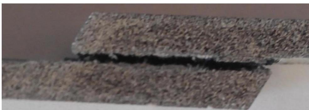
**Figura 4.6.** Rotura num provete de 60°.
