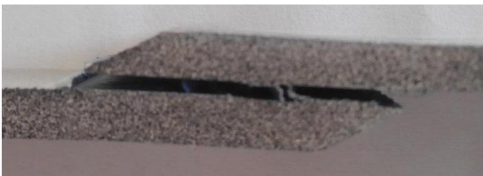
**Figura 4.4.** Rotura num provete de 30°.
