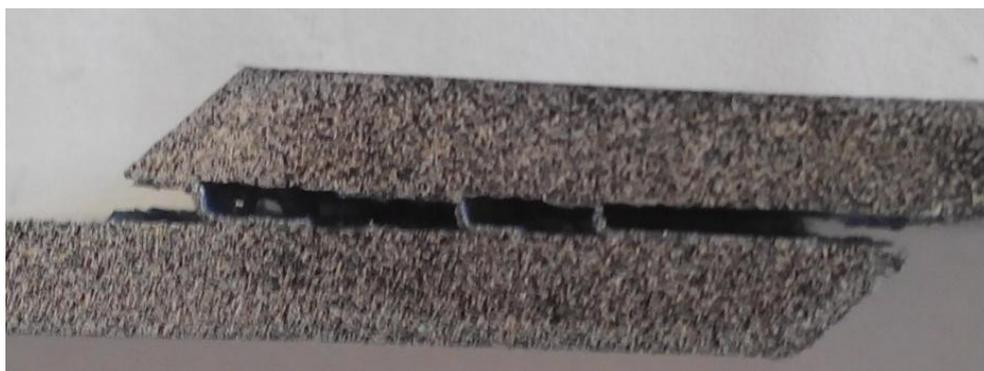
**Figura 4.5.** Rotura num provete de 45°.
