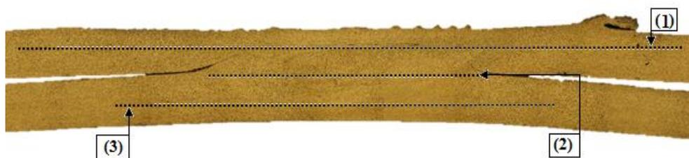
Figura 14 - Esquema das linhas de medição de dureza; (1) - Linha chapa superior; (2) - Linha de Interface; (3) - Linha chapa inferior
