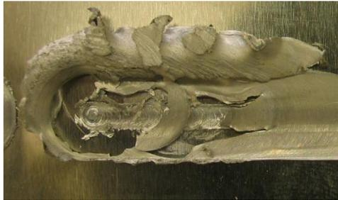
Figura 11 - Representação de uma soldadura com *Flash*
