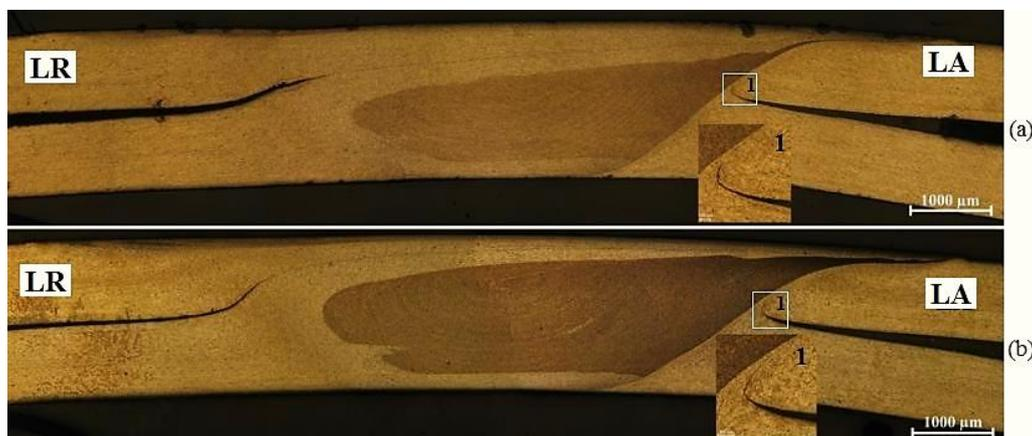
Figura 23 - Secções transversais das soldaduras na liga 6082-T6 com a ferramenta “E1”: (a) - S.6\_E1\_11; (b) - S.6\_E1\_12
