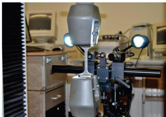
Figura 16 - Equipamento de extensometria ótica (Gom Aramis 5M) [8]
