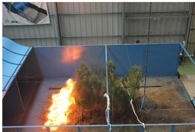
Figura 2.17. Imagem ilustrativa da plataforma de ensaio com um conjunto de árvores no túnel de vento
