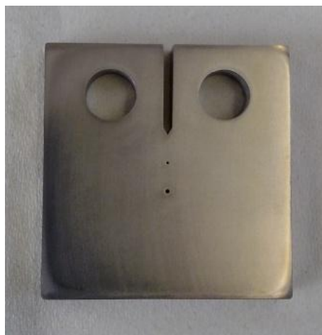
Figura 2.2 – Provete CT com dois furos realizados por eletroerosão (1:1).
