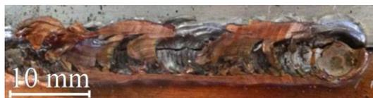
Figura 8 – Presença de cavidades na soldadura realizada por Fertuzinhos, 2012.
