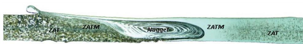
Figura 6 - Microestrutura de uma soldadura tipo do processo *FSW* (Leal, 2011).
