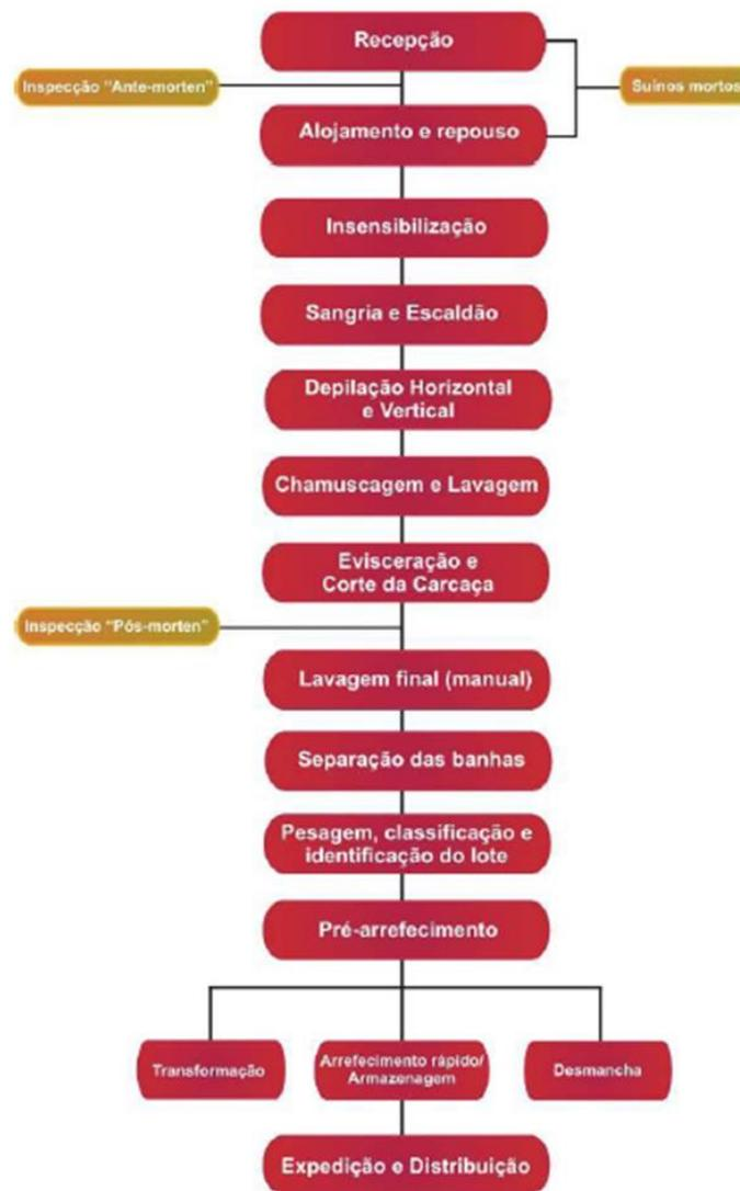
Figura 29. Fluxograma do processo produtivo.
