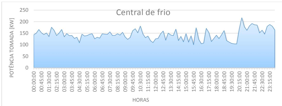
Figura 46. Diagrama de carga do sistema de frio
