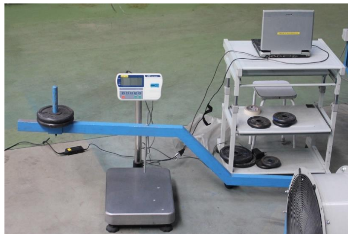
Figura 3.6. Computador e mecanismo que liga a balança à base do GV para registo do decaimento de massa.
