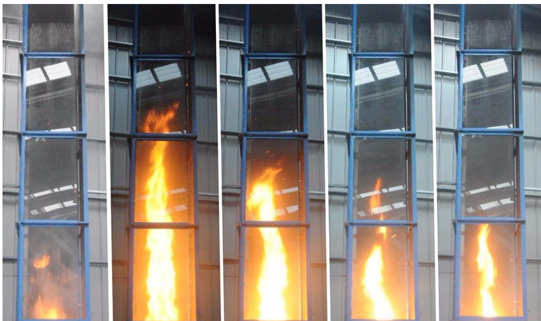
Figura 3.17. Fases do ensaio GVV35 separadas entre 20 segundos.
