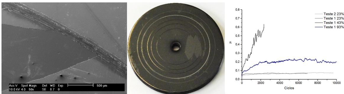
**Figura 4-10** Imagem de SEM de pormenor de zona laminada; Foto do Disco após 5 ensaios com superfície laminada; Gráfico com a evolução média do coeficiente de atrito dos ensaios realizados no revestimento.
