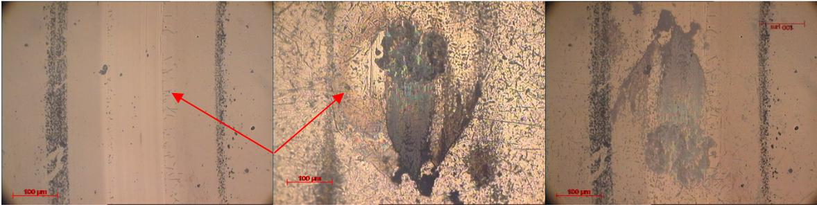
**Figura 4-15** Imagens de microscopia ótica após o teste 2 a 43% de humidade do revestimento WS52CP. Primeira do disco a segunda do pino e a terceira a combinação das duas primeiras onde se verifica que a zona que não tem 3º corpo é a zona de formação de partículas cilíndricas.
