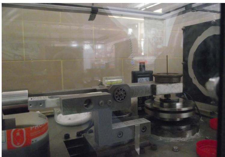
**Figura 3-1** Instrumento de ensaios de pino-disco durante a realização de um ensaio dentro da câmara com humidade controlada.
