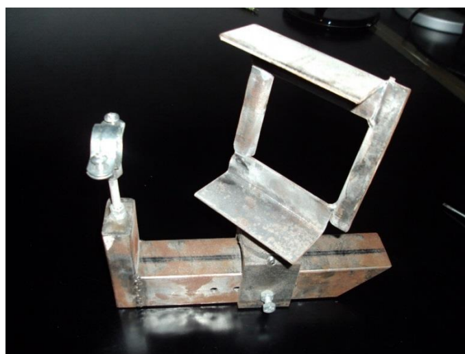
Figura 3-5 Suporte de erosão na posição de 45° a 100 mm de distância do bocal.
