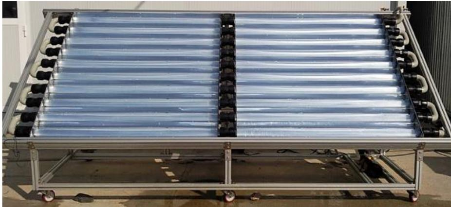
Figura 2.8. Concentrador parabólico composto (PSA, 2013)
