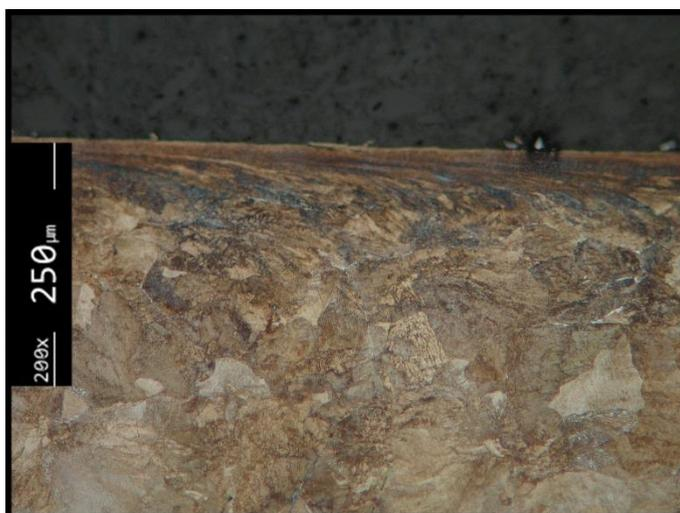
**Figura 4.23.** Micrografia do provete representativo da zona de contacto do carril, do ensaio: 0,75m/s;500MPa;1%.
