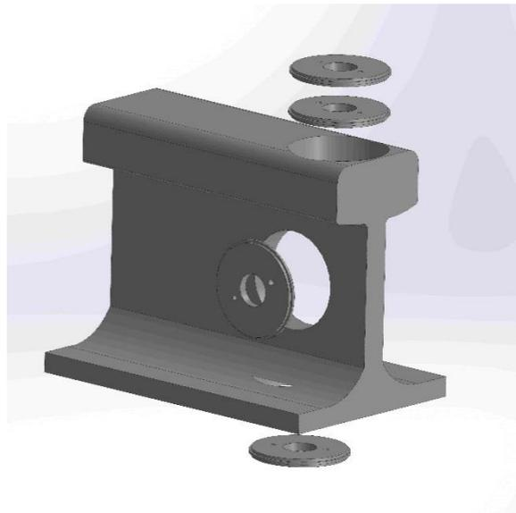
**Figura 3.3.** Secção de carril com esquema de obtenção dos provetes.
