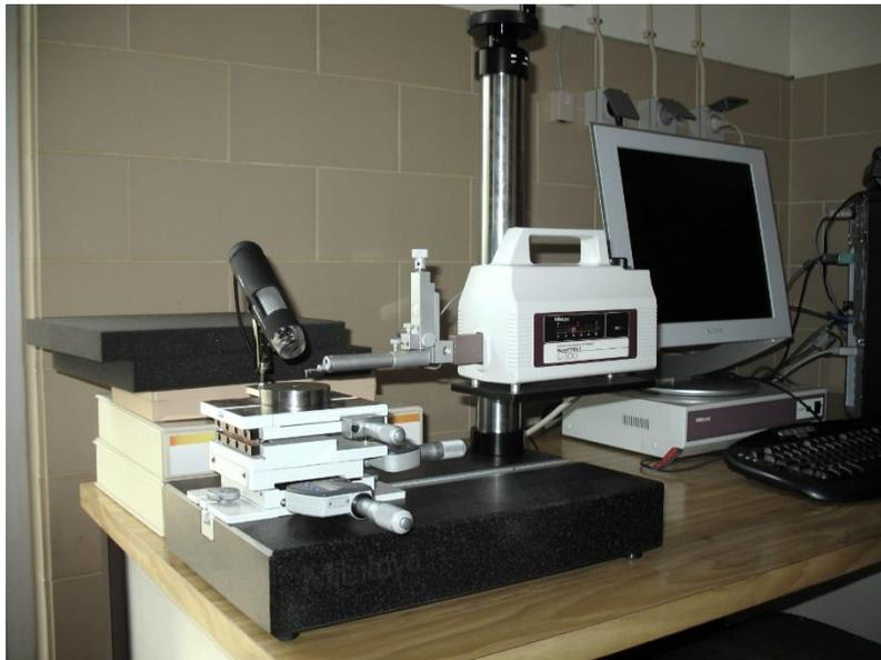
**Figura E. 1.** Rugosímetro *Mitutoyo SJ-500*.
