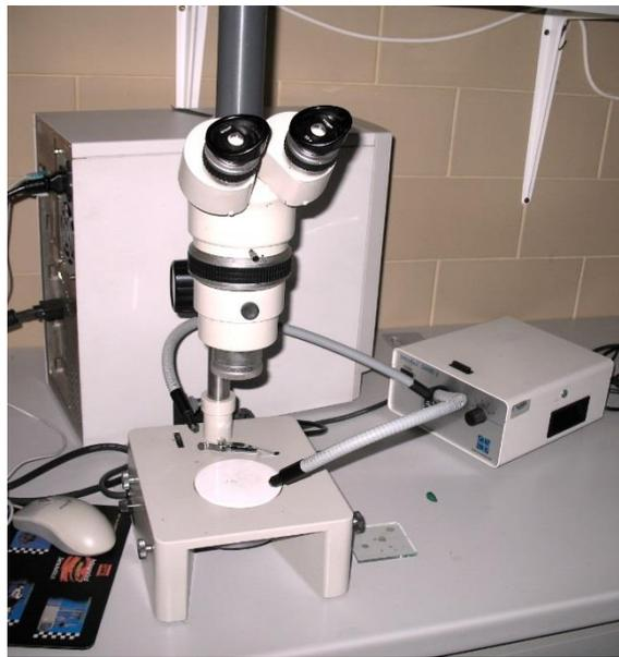
Figura D. 1. Microscópio ótico *Nikon Stereo Photo SMZ-10*.
