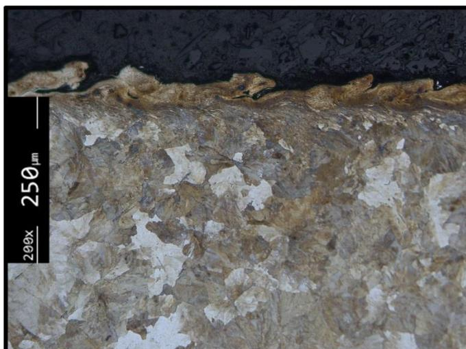
**Figura 4.29.** Micrografia do provete representativo da zona de contacto do carril, do ensaio: 1m/s;500MPa;0,2%.
