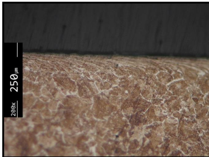
**Figura 4.27.** Micrografia do provete representativo da zona de contacto da roda, do ensaio: 1m/s;600MPa;1%.
