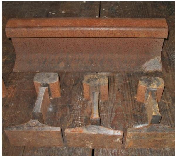
**Figura 3.2.** Secção de carril e secções após o corte.
