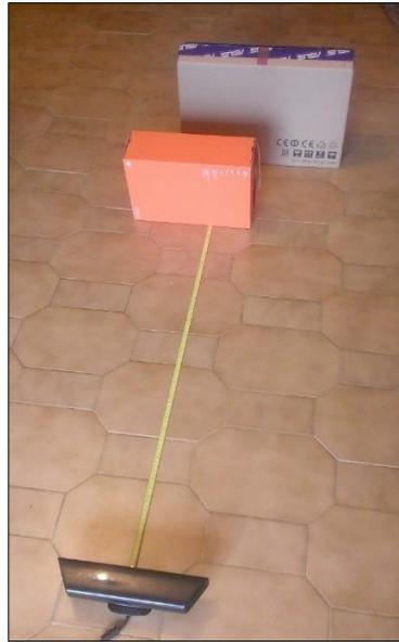
**Figura 3.3.** Teste de identificação da posição dos objetos nas imagens obtidas com o Kinect.
