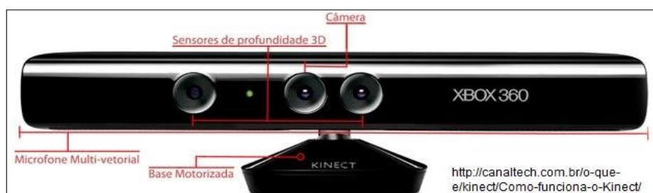
Figura 2.2. Constituição do Kinect.
