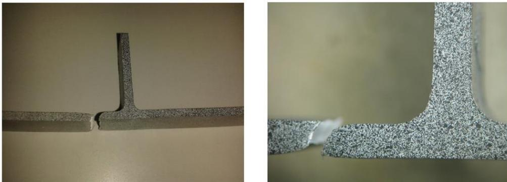
**Figura 4.14** Fratura da série ADFD em tração normal
