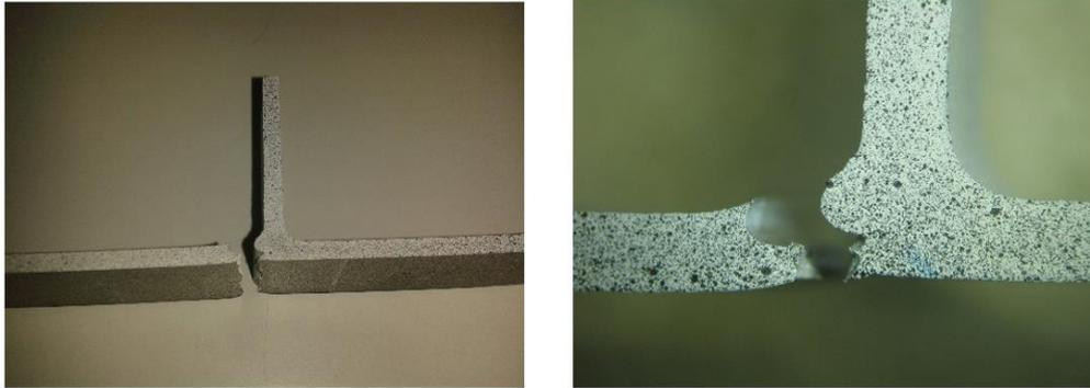
**Figura 4.13** Fratura da série ACE 5 em tração normal
