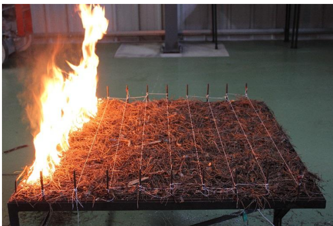
Figura 9:Determinação da velocidade básica de propagação, R_0 .
