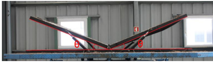
Figura 4: Representação do ângulo \theta , formado entre o painel C e a mesa.
