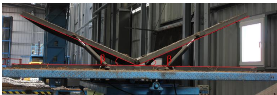
Figura 3: Representação do ângulo \beta , formado entre o painel A, e a mesa.
