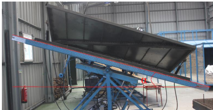
Figura 5: Representação do ângulo \alpha , entre a mesa e a horizontal.
