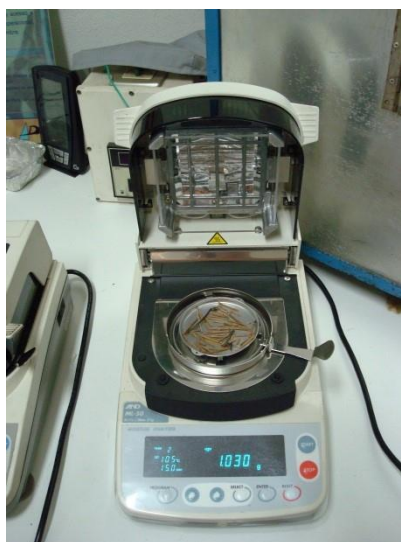
Figura 8: Medidor de humidade da A&D.
