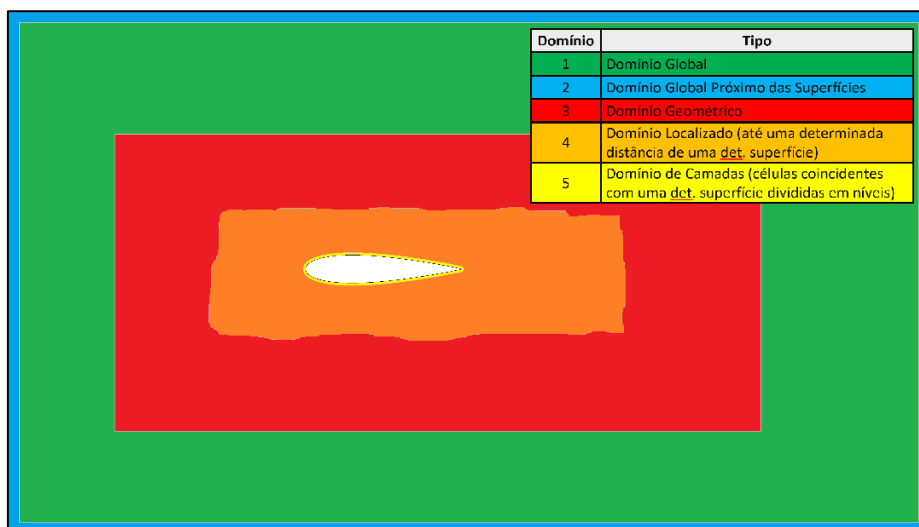
Fig. 3.3 Representação dos domínios de malha gerados usando o cfMesh.
