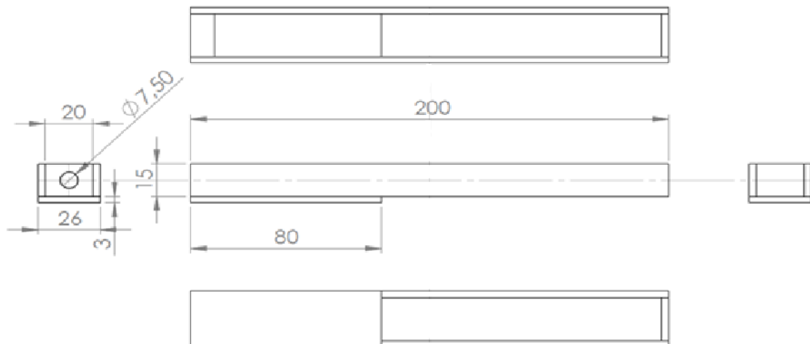
Figura D.1. Desenho da caixa de acrílico utilizada no ensaio UEW3.
