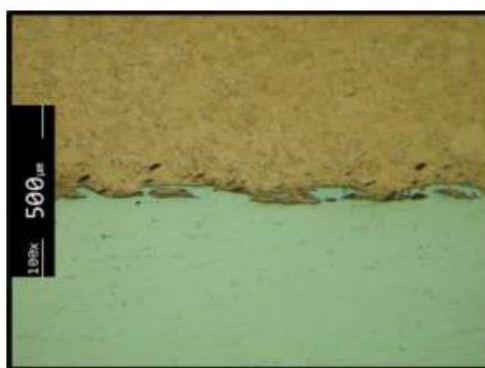
Figura 2.6. Morfologia da interface Cu-Al (Dias, 2012).
