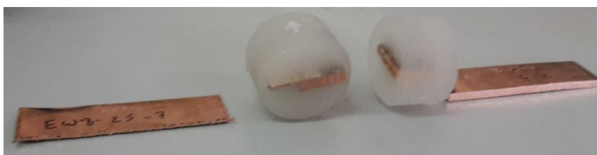
Figura 3.8. Aspeto final das amostras na resina e sua localização nas amostras.
