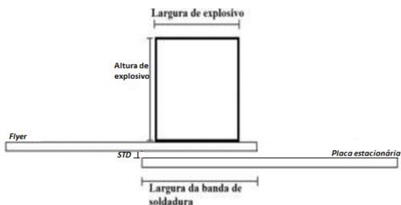
Figura 3.2. Esquema de montagem dos ensaios de soldadura.
