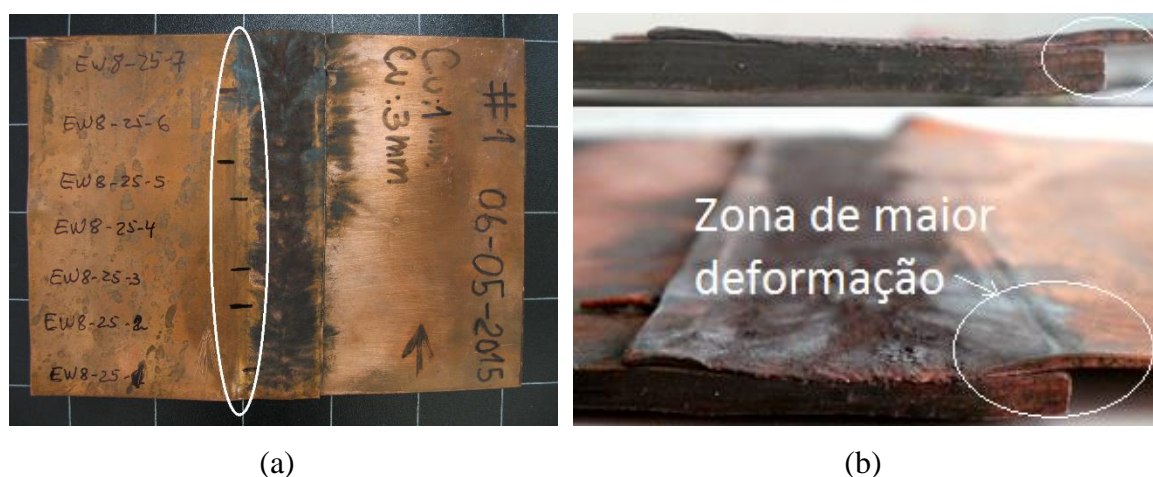
Figura 4.3. Soldadura EW8: (a) Vista geral; (b) Detalhe da zona soldada.
