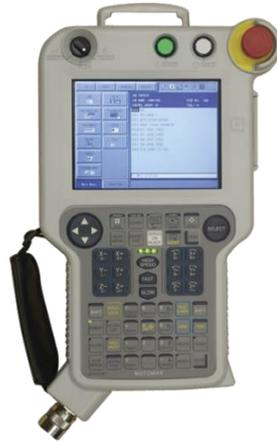
**Figura 1.2.** Exemplo de comando usado para a programação por método tradicional, *Teach pedant*.
