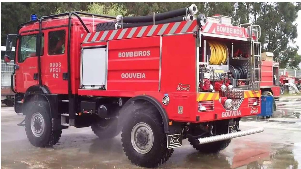
**Figura 2.6.** Viatura dos bombeiros de Gouveia com sistema proteção de sprinklers (foto: CEIF/ADAI).
