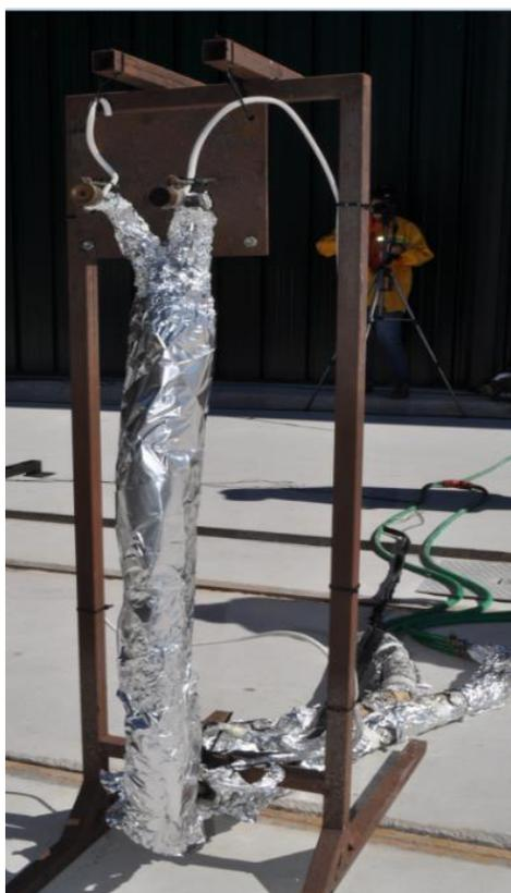
**Figura 3.7.** Sensores de fluxo de calor da Vattel (foto: CEIF/ADAI).
