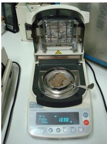
**Figura 3.12.** Medidor de humidade (foto: CEIF/ADAI).
