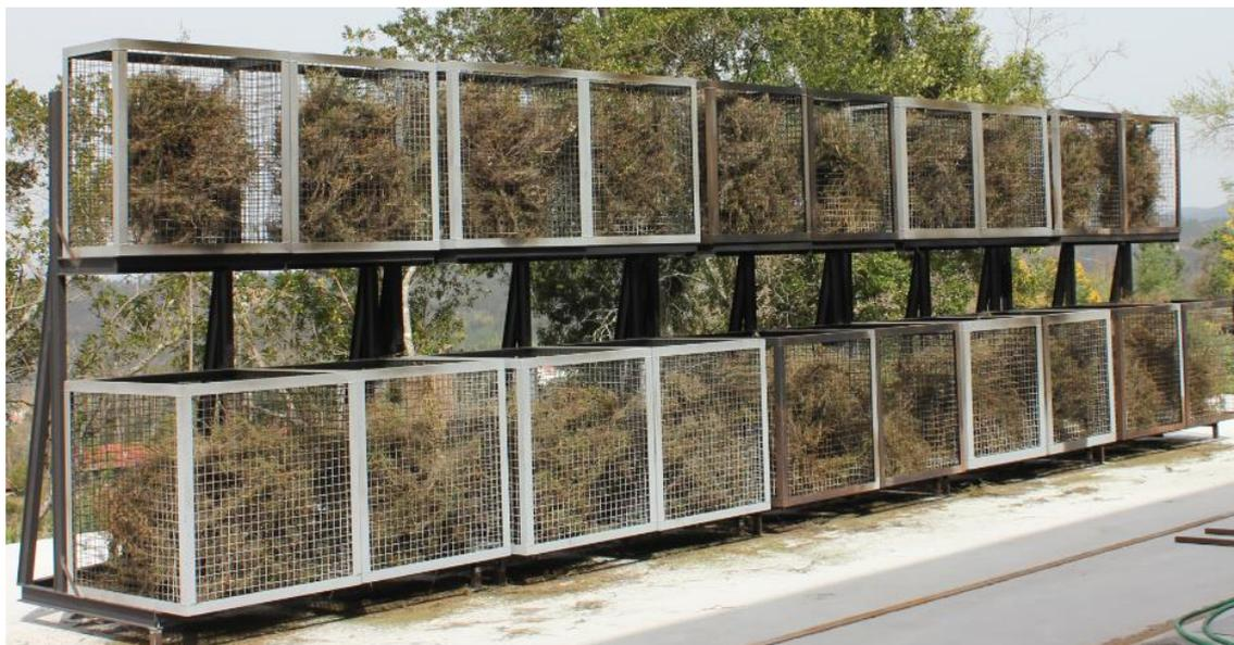
**Figura 3.2.** Simulador frente de fogo carregado com combustível (foto: CEIF/ADAI).
