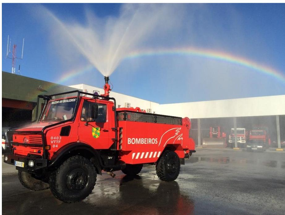
Figura 2.8. Viatura dos bombeiros de Macedo de Cavaleiros com sistema proteção de canhão de água (foto: CEIF/ADAI).
