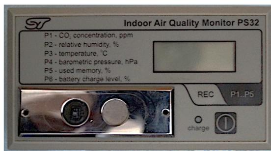
Figura 2.6. Analisador de CO<sub>2</sub> (PS32).
