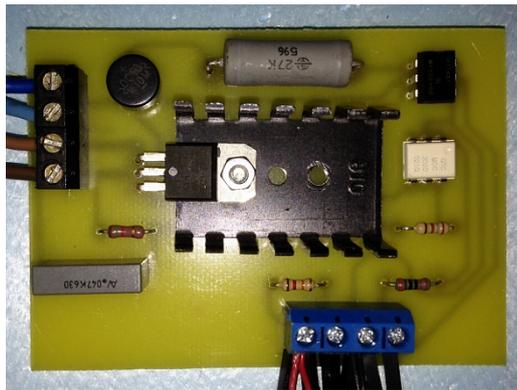
**Figura 4.2.** Dispositivo de controlo da velocidade de rotação do motor (Dimmer).
