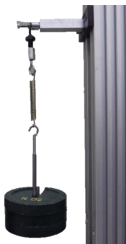
Figura 3.8-Fotografia exemplificativa do cálculo da constante da mola.
