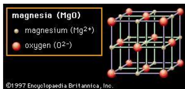
Figura 1.5 O arranjo de íons de magnésio e oxigênio em magnésia (MgO); um exemplo da estrutura de cristal de sal de rocha (Anon., 1997).
