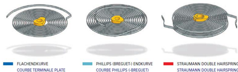
Figura 3.5. Diagrama de comparação do efeito de Grossmann com outros 2 tipos de geometrias de espirais
