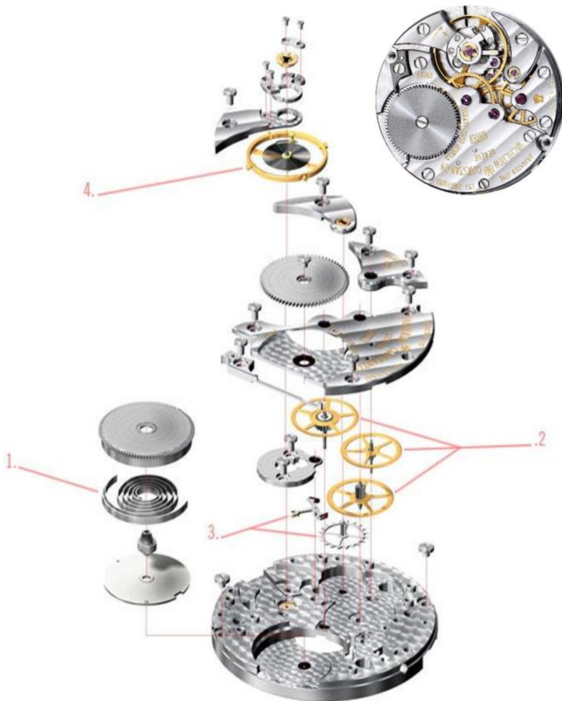
Figura 2.5. Vista esquemática explodida de um movimento mecânico comum
