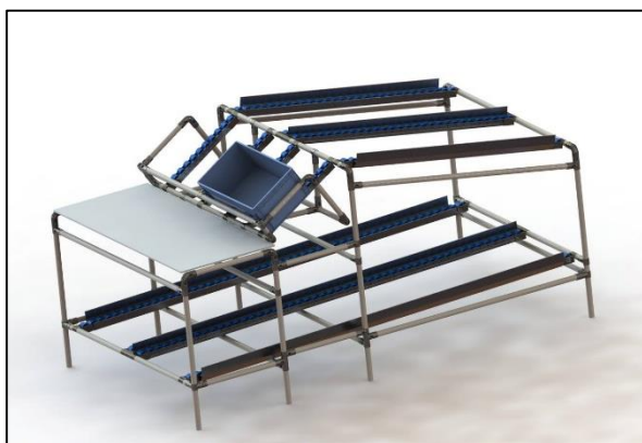
Figura 33-Mesa para pré montagem de rear heaters
