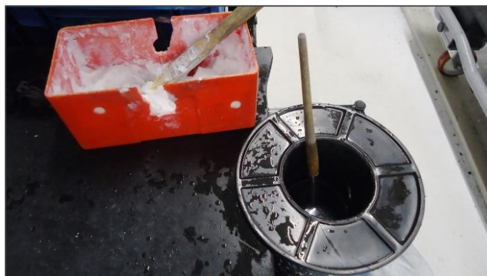
Figura 39- Lubrificantes utilizados na pré montagem do rear heater
