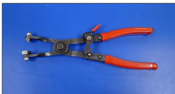
Figura 35- Alicate manual para aperto das abraçadeiras
