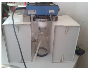
Figura 4 - Sistema de aquecimento para a remoção do Sn dos filmes.
