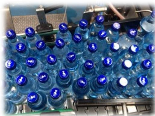
**Figura 5.8.** Garrafas com excesso de pressão na entrada do Repartidor
