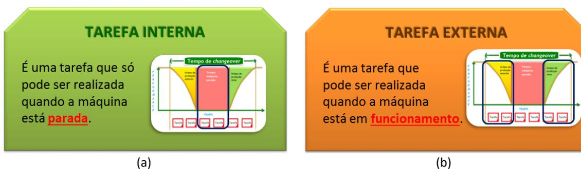
Figura 2.9. Definição de Tarefa Interna (a) e Externa (b) (Fonte: Adaptado de Heineken, 2014)
