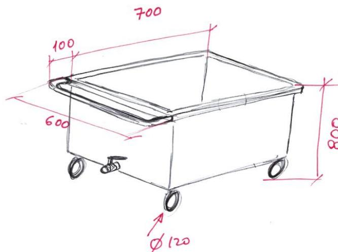
Figura 5.10. Esboço do carro de lavagem (mm)
