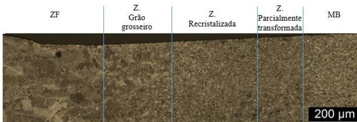
Figura 41 – ZTA para a soldadura TIG\_DC\_CP.
