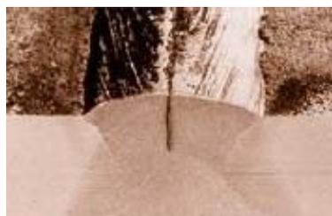
Figura 9 – Fissuras na solidificação
