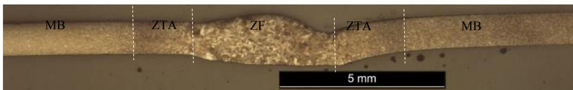
**Figura 39** – Soldadura TIG\_DC\_CC.
