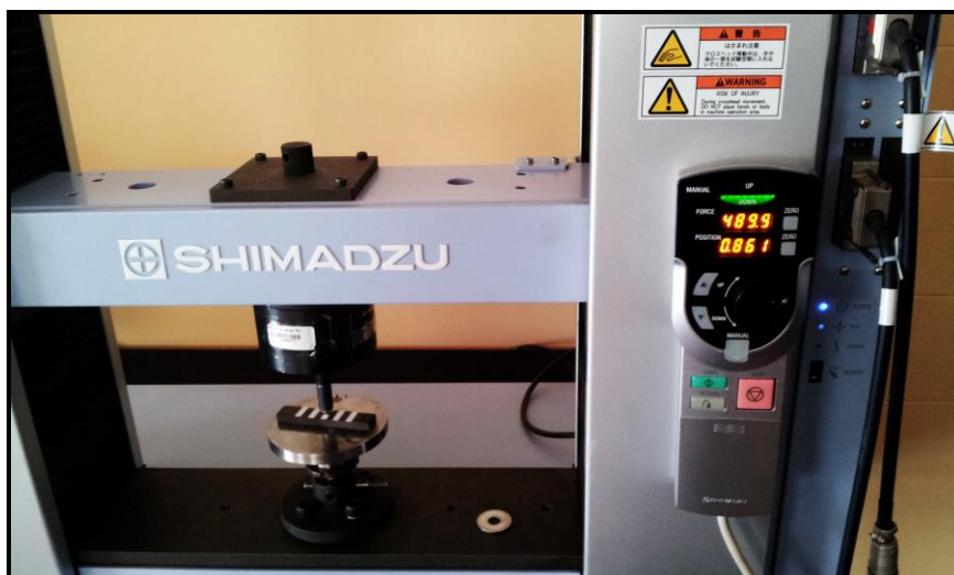
Figura 3.16 Ensaio de dureza a 490 N, com uma esfera de 10mm, durante 60s.
