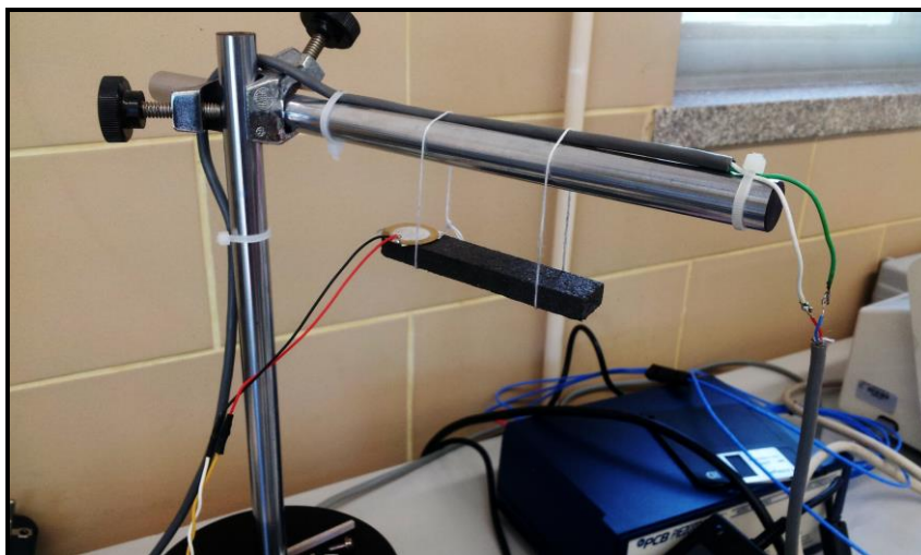
Figura 3.20 Ensaio do módulo de elasticidade à temperatura ambiente.
