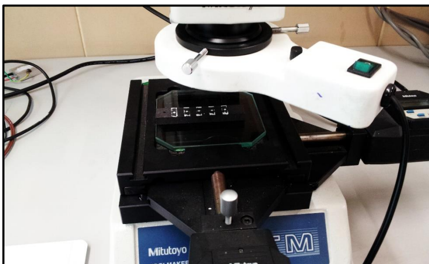
Figura 3.18 Medição das indentações através do uso no microscópio óptico com mesa micrométrica.
