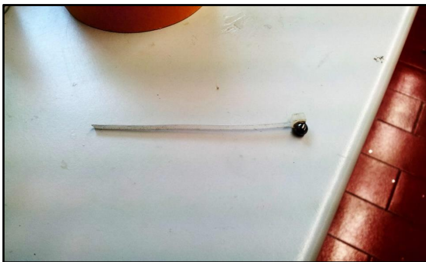
Figura 3.19 Esfera de 4 mm aplicado na extremidade de um corpo flexível para auxílio no ensaio do módulo de elasticidade.
