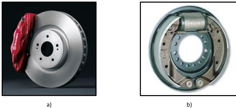
Figura 2.1 Sistema de travagem de: a) disco; b) tambor (sem cobertura exterior).
