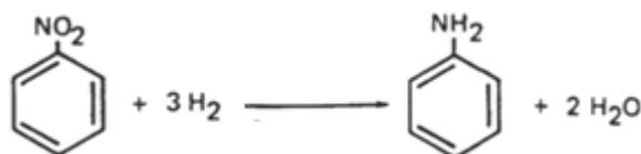
Figura C.1 – Processo de hidrogenação do MNB em ANL.
