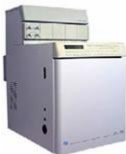
Figura 19 – Cromatógrafo de gás (DANI (Milan, Italy) GC1000) utilizado para a realização de análises de superfície de xilanas.
