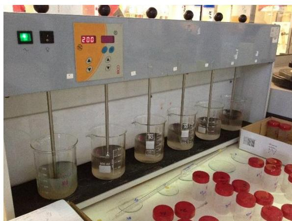
Figura 7 - Sistema reacional para a reação de Fenton.
