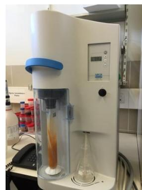
**Figura 13- Unidade de Digestão (VELP Scientifica - DKL Heating Digester).**
