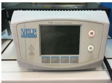
**Figura 12 - Unidade de destilação (VELP Scientifica - UDK 129 Distillation Unit).**
