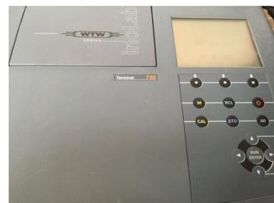
Figura 11 - Equipamento de medição de Oxigénio Dissolvido (WTW Series inoLab Terminal 740).
