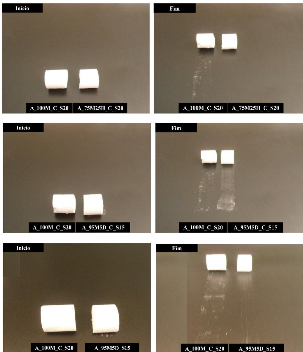
Figura 28 – Resultados do teste de inspeção visual de libertação de pó dos aerogéis sintetizados com os co-precusores HTPDMS e DMDMS, em comparação com o aerogel derivado de MTMS.
