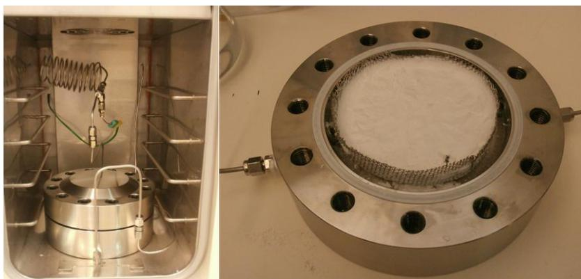
Figura 16 - Célula de alta pressão testada para caixas de Petri.
