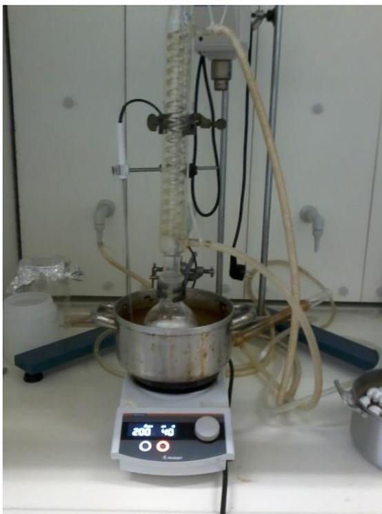
**Figura 13** – Montagem utilizada na fase de ativação da celulose e da sílica.
