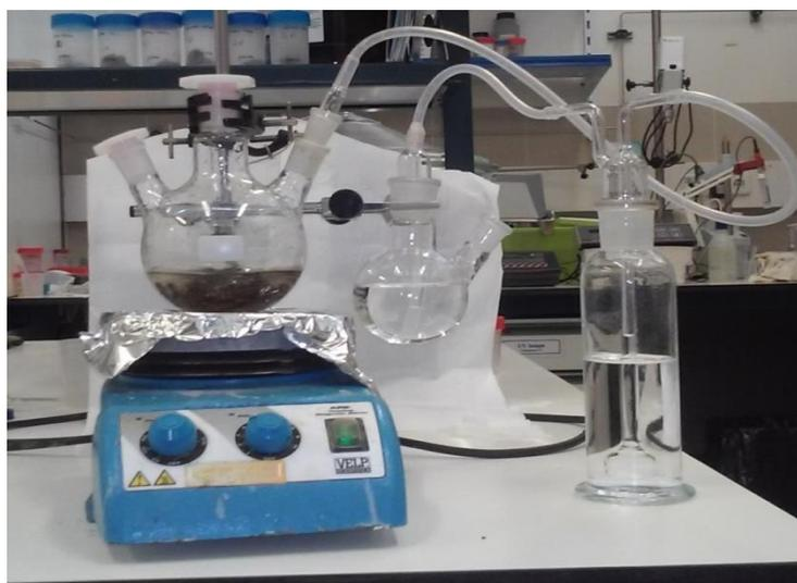
**Fig. 5.14** – Montagem experimental da metodologia *semi-batch* usada para efetuar o processo de estabilização química do resíduo
